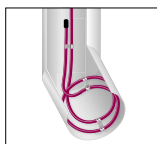
Монтаж кабеля на плоскую крышу с внутренним сливом
